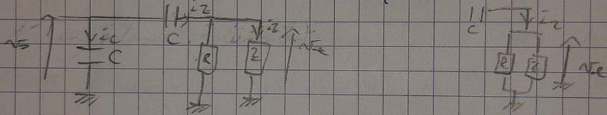
On a aussi  $v_e$  tension de C impédance équivalente  $Z$  et  $R$  en parallèle.
