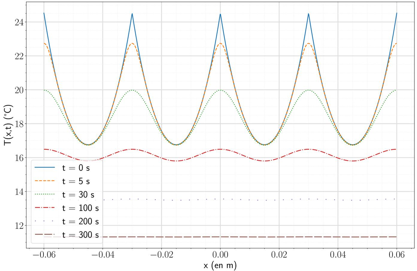
**Fig. 1** – Profil de température à différents instants, à partir de  $t = 0$  lorsque le désembuage est désactivé.
